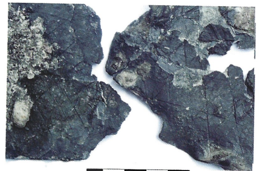
Clous bronze, en fer et doublure de coque en plomb, avec marques sur le plomb.
